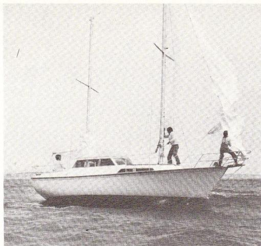
Le gréement de ketch facilite les manœuvres de voiles. Le bout dehors avec son solide balcon a été apprécié par l'équipier d'avant.
